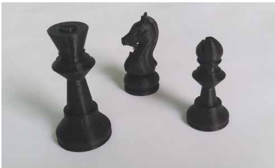
Acido polilattico. Polimero termoplastico di derivazione naturale, biodegradabile. I campioni in foto sono stati ottenuti attraverso la tecnica di stampa 3D nota come FFF (Fused Filament Fabrication) a partire da un filamento di materiale polimerico
